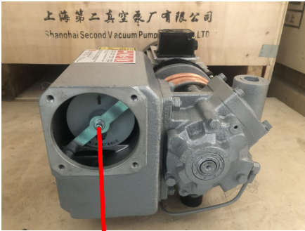
拆卸顶片将排气滤芯取出
